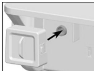
① Stecken Sie den CAN-Dongle an.
