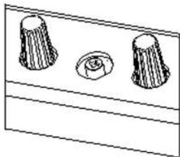
Unterhalb des Arztgerätes kann für die Instrumente die Intensität für das Spray reguliert werden. Die Anordnung der Ventilgruppen (3-fach) für ein Instrument ist entsprechend der Instrumentenreihenfolge in den Ablagen. Die Sprayintensität kann über die Drehregler eingestellt werden. Die Treibluft für die Turbine oder Kühlluft für den Motor können mit einem Kreuzschlitzschraubendreher eingestellt werden.
